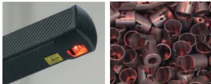
高低差の激しい対象ワークにも的確にパターン投影します
